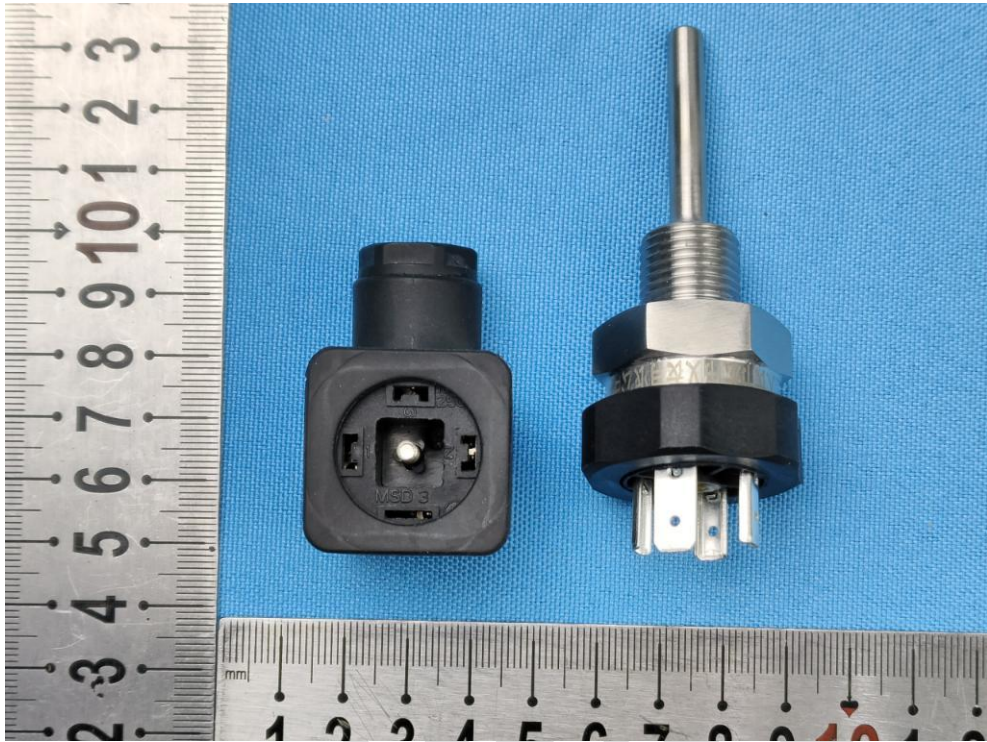
图 3: 测试后, 样品拆解图片
